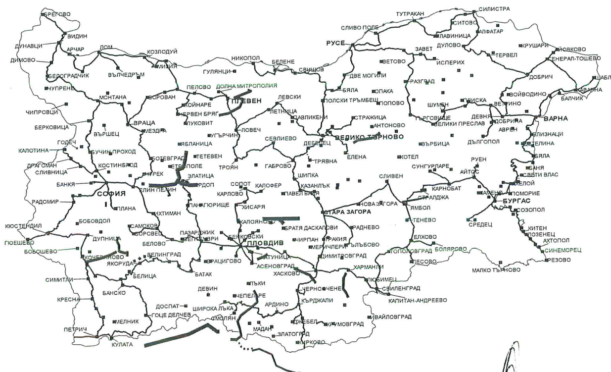
Оптична кабелна мрежа на БТК ЕАД
