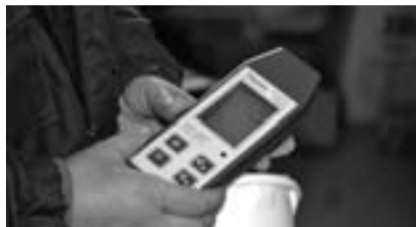
Контролна зала - измерване фона на работната среда
