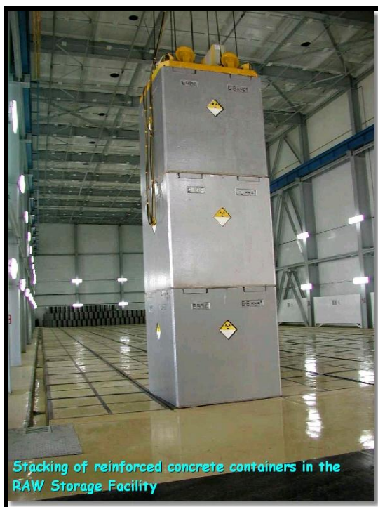
FIGURĂ 2.2-4 CONTAINERE DIN OȚEL BETON PENTRU ÎNGROPAREA DRA ÎN DNDRA
